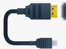
**Entrada MHL (Enlace Móvil de Alta Definición):** Es una entrada físicamente idéntica a la HDMI, pero que permite mediante un cable micro USB-HDMI, conectar la salida micro USB de un smartphone o una tableta electrónica que soporte el estándar MHL a la pantalla para reproducir video de alta definición grabado en éstos últimos. Soporta video en 1080p y audio ambiental digital de 7.1 canales y es posible controlar el smartphone y la tableta desde el control remoto de la pantalla.
