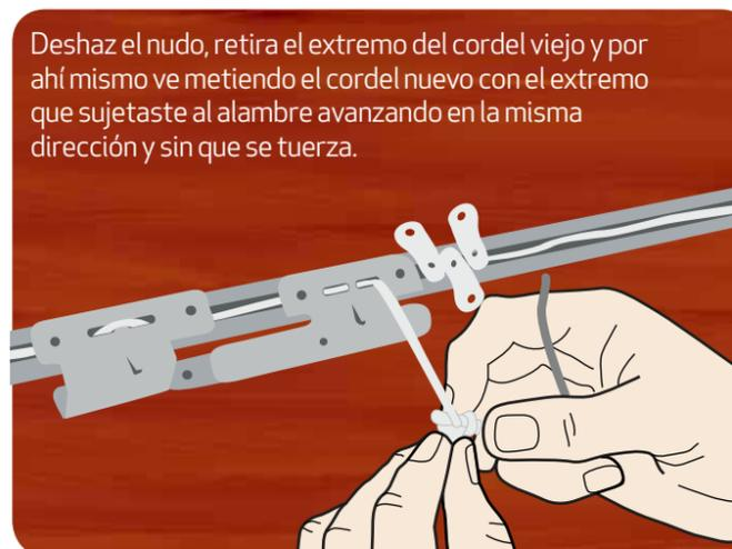
Deshaz el nudo, retira el extremo del cordel viejo y por ahí mismo ve metiendo el cordel nuevo con el extremo que sujetaste al alambre avanzando en la misma dirección y sin que se tuerza.
